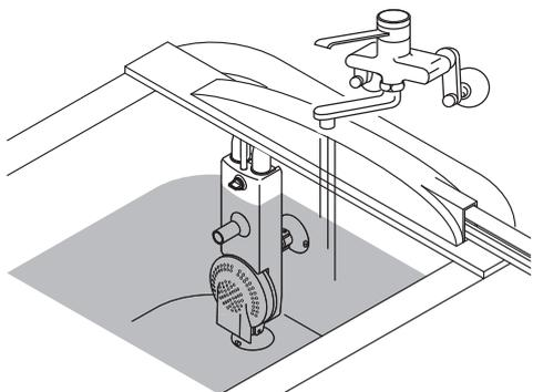
10 バスケットにろ過材（2袋）を入れ、内蓋を置いてバスケットキャップを閉める。
