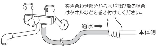
**4** 泡出しユニットのジェットノズルから水が出てきたら通水を終了する。
