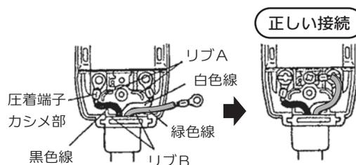
傾斜センサー用リード線（緑）圧着端子は左上図のように真横に向けてください。圧着端子が端子カバー取付ねじ穴にかかると端子カバーが閉まりません。
