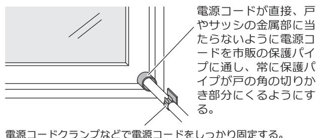
電源コードクランプなどで電源コードをしっかり固定する。
