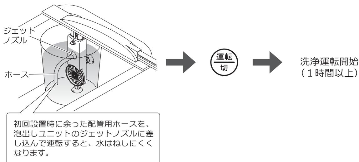
7 1時間以上運転したら、一度運転を停止してバケツ内の専用洗剤を排水し、きれいな水をバケツに入れてすすぎ運転を開始する。すすぎ運転はバケツ内の水が濁らなくなるまで繰り返し行ってください。
