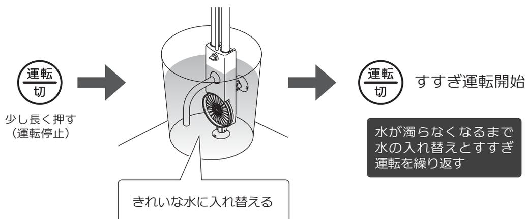
8 すすぎ運転が終わったら、バケツから泡出しユニットを取り出して浴槽に固定し、フィルターセットを泡出しユニットに取り付ける。
